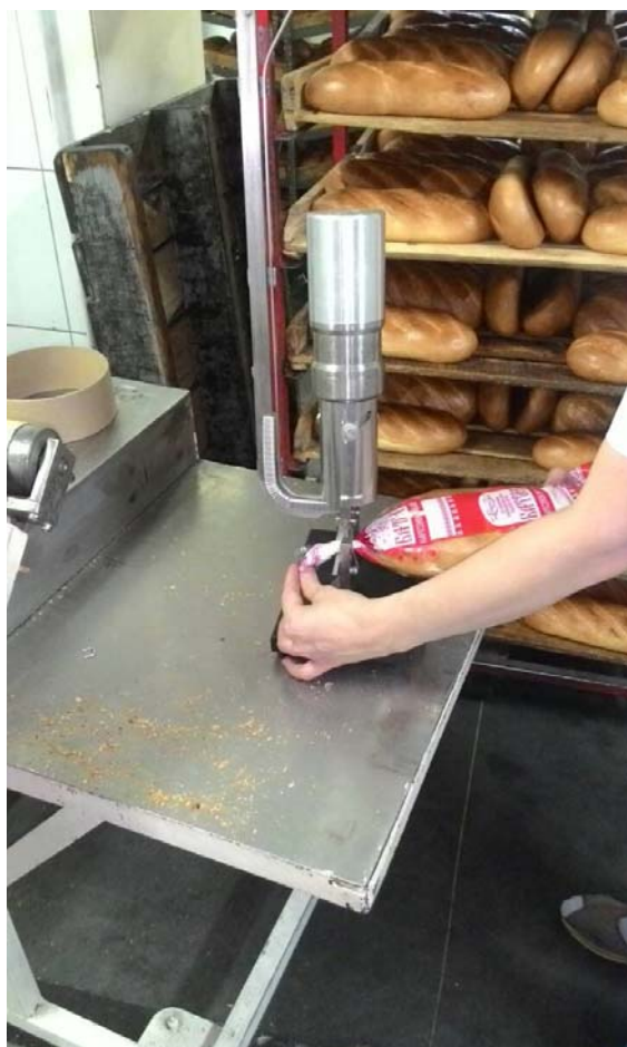
Рисунок 36 – Производственные испытания ЛЭМД-привода устройства клипсования упаковки сельхозпродукции на предприятии ОАО «Знак Хлеба»
