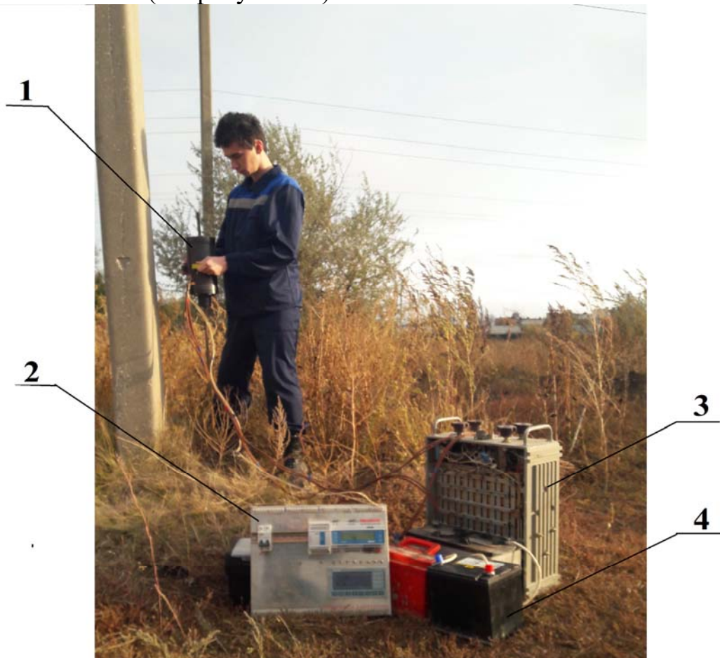
Рисунок 37 – Полевые испытания ЛЭМД-привода для погружения продольно-неустойчивых стержневых элементов в грунт: 1 – электромагнитная ударная машина; 2 – устройство управления; 3 – емкостной накопитель энергии; 4 – аккумуляторный источник питания
