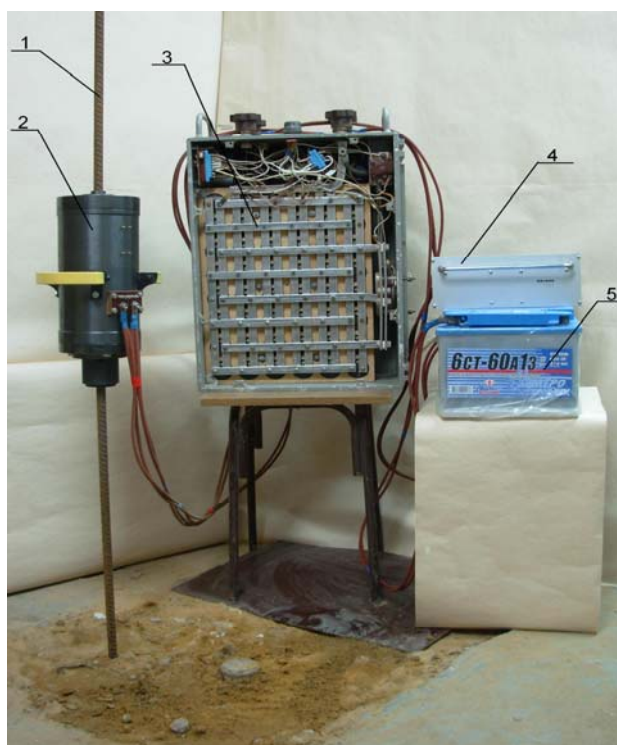
Рисунок 31 – Общий вид физической модели: 1 – забиваемый стержень; 2 – ударная машина с ЛЭМД; 3 – электрический преобразователь с емкостным накопителем энергии; 4 – конвертор; 5 – аккумуляторный источник питания
